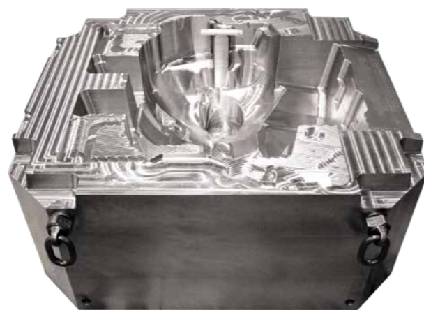
Formhälfte vorgefräst inkl. Tieflochbohren
